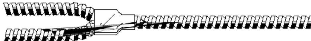
Cabos de fibra ótica bifurcados são usados para os modos de detecção difusa ou retrorefletido.
