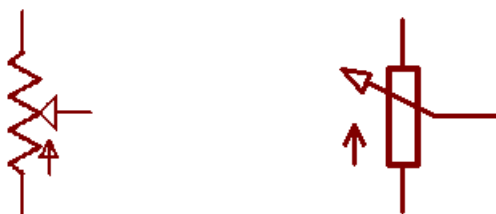
Figura 24: Símbolos do potenciômetro utilizados em esquemas eletrônicos. À esquerda a simbologia americana e à direita a européia.
