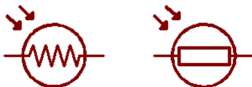
Figura 6: Símbolos do LDR utilizados em esquemas eletrônicos. À esquerda a simbologia americana e à direita a europeia.
