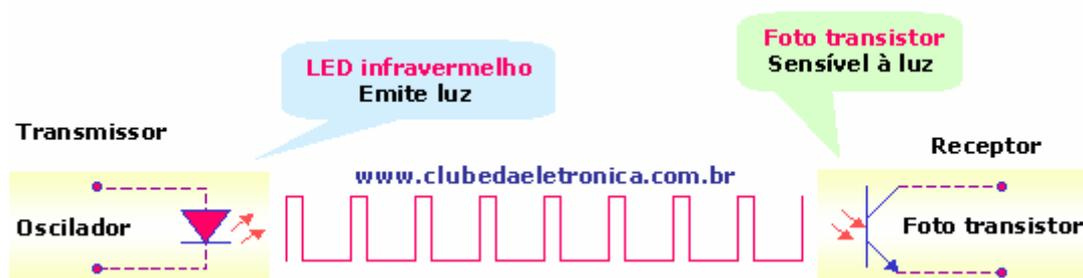
A frequência de modulação do e recepção devem ser a mesma. Assim, o receptor somente será sensível a luz do transmissor ignorando a luz do ambiente. Em alguns sensores o transmissor e o receptor estão alojados em um único encapsulamento.
