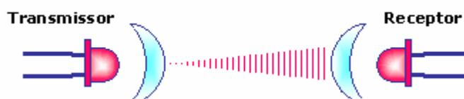
Nota: A poluição do ambiente (poeira e umidade) pode interferir no funcionamento do sensor. Assim, deve-se periodicamente limpar os espelhos e as lentes dos sensores.
