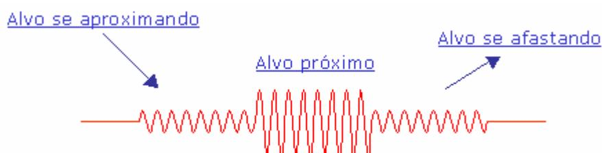
À medida que o objeto se aproxima a capacitância do circuito oscilador aumenta, aumentando assim, a amplitude da oscilação até que ON point seja alcançado, comutando a saída de baixo para alto. Ao se afastar do sensor a capacitância diminui e a amplitude da oscilação é reduzida até que Off point seja atingido, neste momento a saída comuta de alto para baixo. Veja ilustração:
