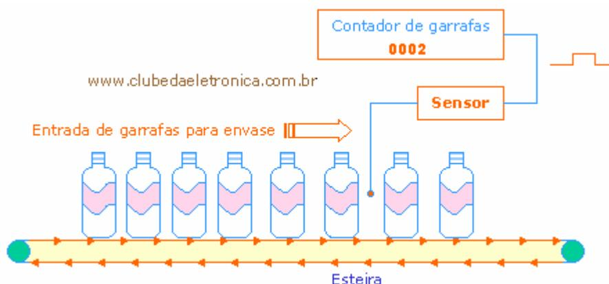
Um sistema bastante simples, onde um sensor é usado para detectar e contar garrafas que passam por uma esteira. O funcionamento é bastante simples toda vez que o sinal do sensor é interrompido, sua saída comuta de baixo para alto, enviando um sinal a um dispositivo contador que incrementa “1” a cada passagem de garrafa.
